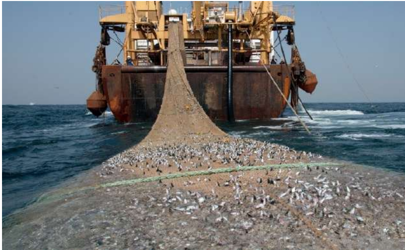
Fig 13 : Particolare di rete a volante gigantesca applicate ad peschereccio fattoria
